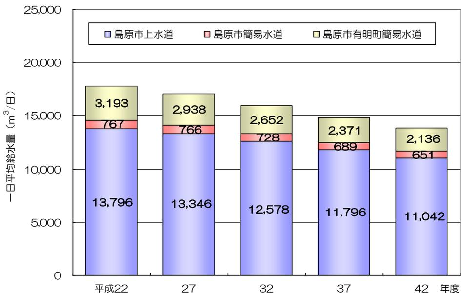
図 4.6 一日平均給水量の推計結果
