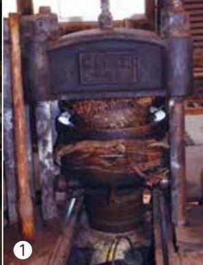
①日本で唯一の「玉締め式圧搾機(昭和12年製)」
