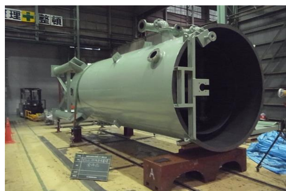
活性炭吸着塔
