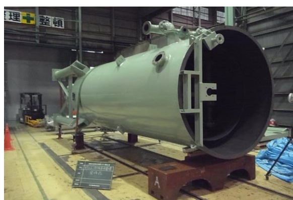
活性炭吸着塔
