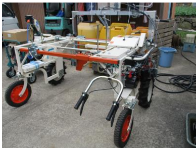
トンネル支柱打込機
