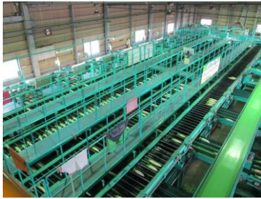
大根洗浄選別施設
