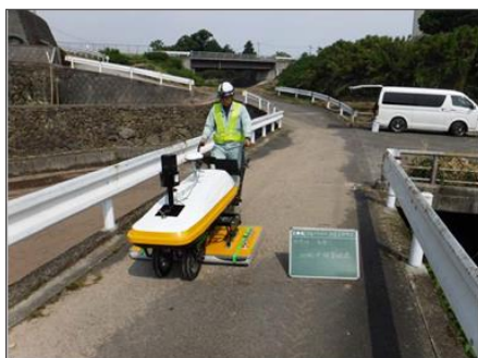
地中レーダ探査状況
