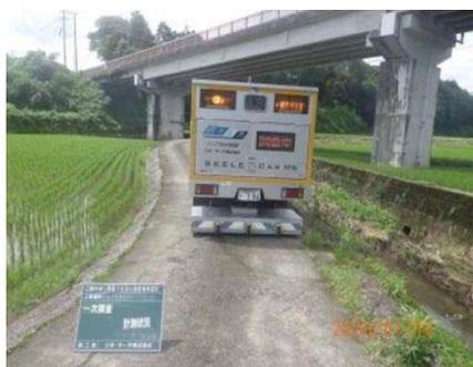
路面下空洞探査車計測状況
