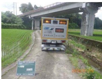
路面下空洞探査車計測状況
