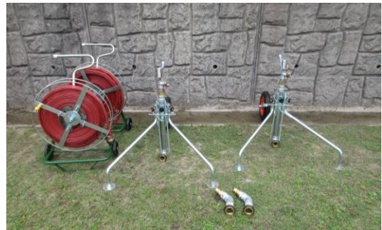
散水設備 2組 (スプリンクラー、ホース、ジョイント等)
